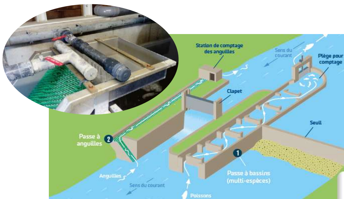
Figure 90 : Schéma de la passe à poissons et de la passe à anguilles sur le bras principal avec photo de l'intérieure de la station de comptage des anguilles (schéma CD17-CMCS)
