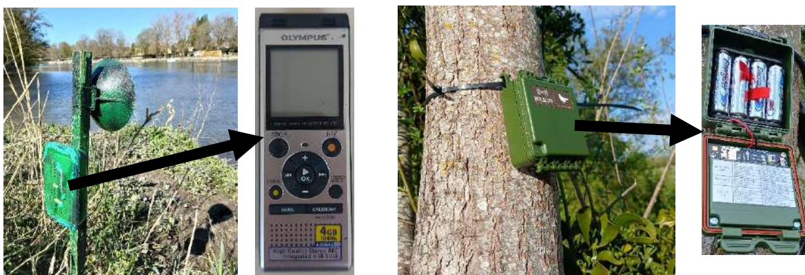
Figure 101 : Enregistreur OLYMPUS (à gauche) contenu dans le boîtier, avec parabole et enregistreur SMM (à droite) installé dans un arbre face à la frayère (photos ©Audrey Postic-Puivif).
