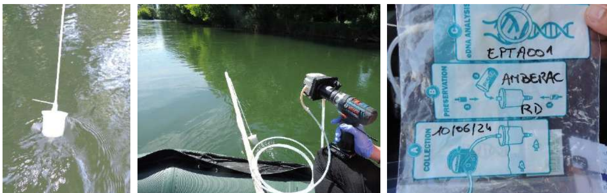
Figure 75: capsule en cours de filtration, système de pompage et conditionnement pour envoi au laboratoire
