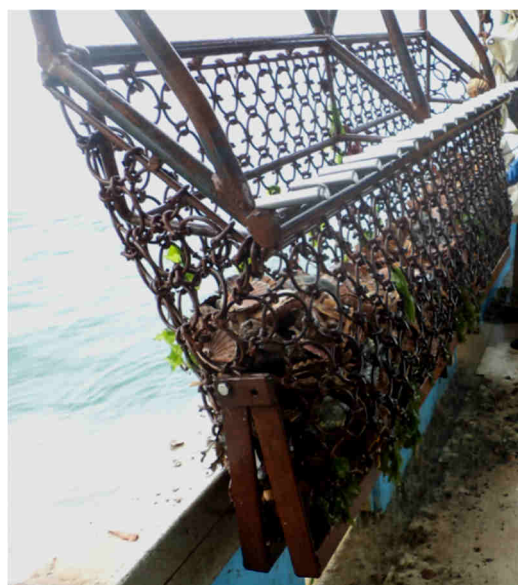
Figure 5 : Drague utilisée par les professionnels et durant la campagne de suivi du stock de coquilles Saint-Jacques
