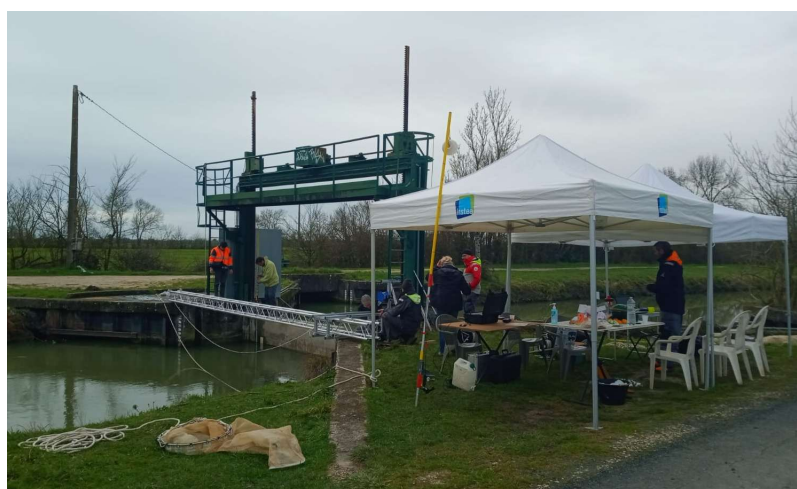
Figure 66 : Expérimentation avec caméra et filet bongo organisée par le Pôle Écohydraulique et l'UNIMA
