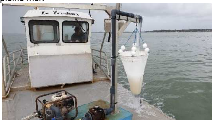
Figure 2 : Structure de pêches de larves par pompage.
