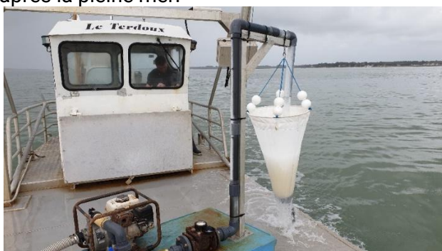
Figure 2 : Système de pompage pour les prélèvements de larves.
