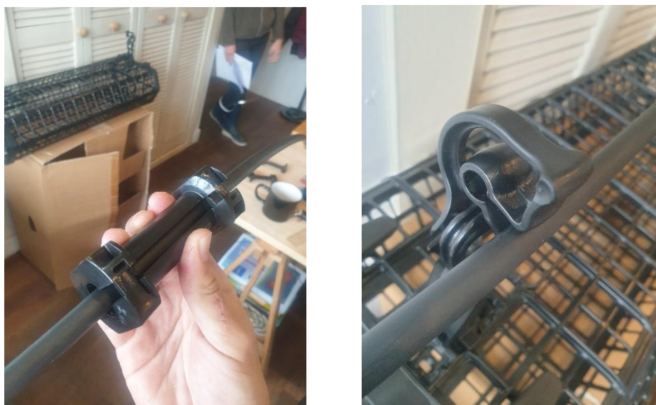
Figure 36 : Système de fixation des casiers sur les supports d'élévation avec à gauche le système de mâchoires Seapa et à droite la fixation directe sur gaine Hexcyl.
