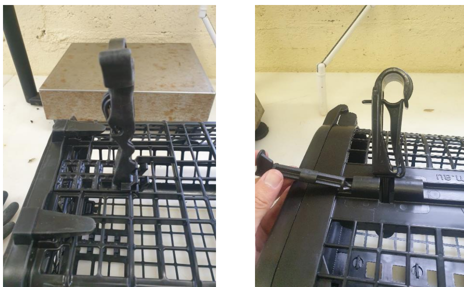
Figure 35 : Système de fixation des crochets de casiers australiens (à gauche) Hexcyl et (à droite) Seapa
