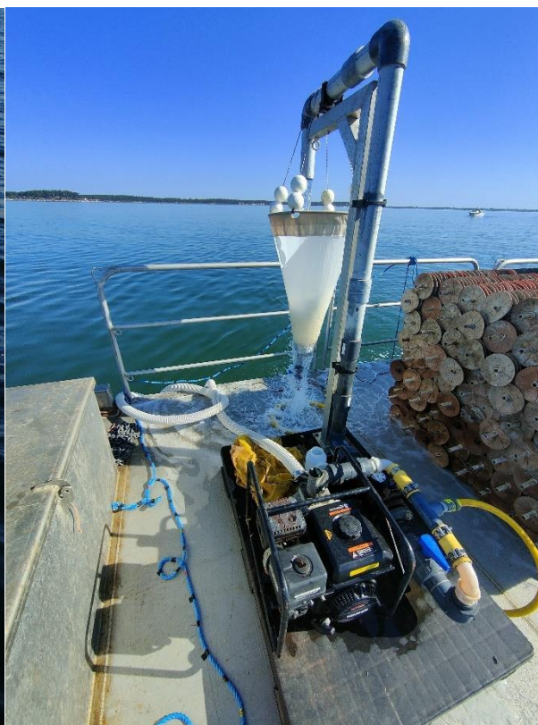
Figure 4: Prélèvement de l'ensemble de la colonne d'eau par immersion d'un filet à plancton contenu dans une cage. Figure 5: Prélèvement à -1m par pompage de 1,5m 3 d'eau.
