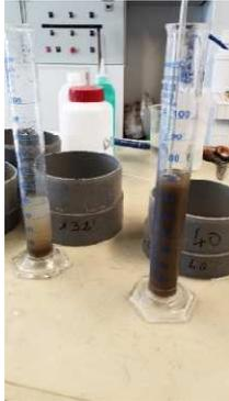
Figure 3 : Eprouvettes avec échantillons filtrés sur 40 µm et 132 µm.
