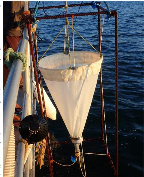
Système de prélèvement de l'ensemble de la colonne d'eau par cage immergée
