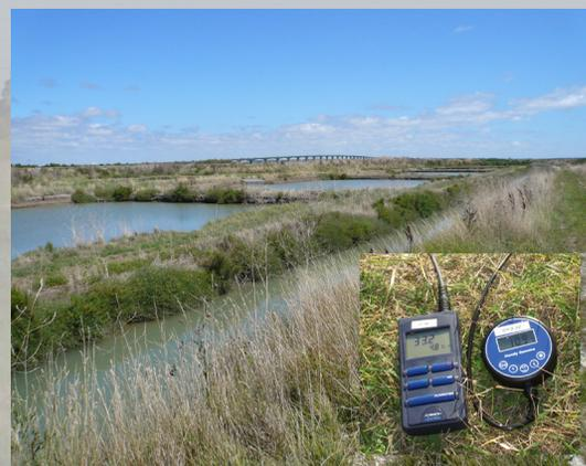
Conductimètre et oxymètre destinés aux mesures des paramètres physico-chimiques dans le marais salé
