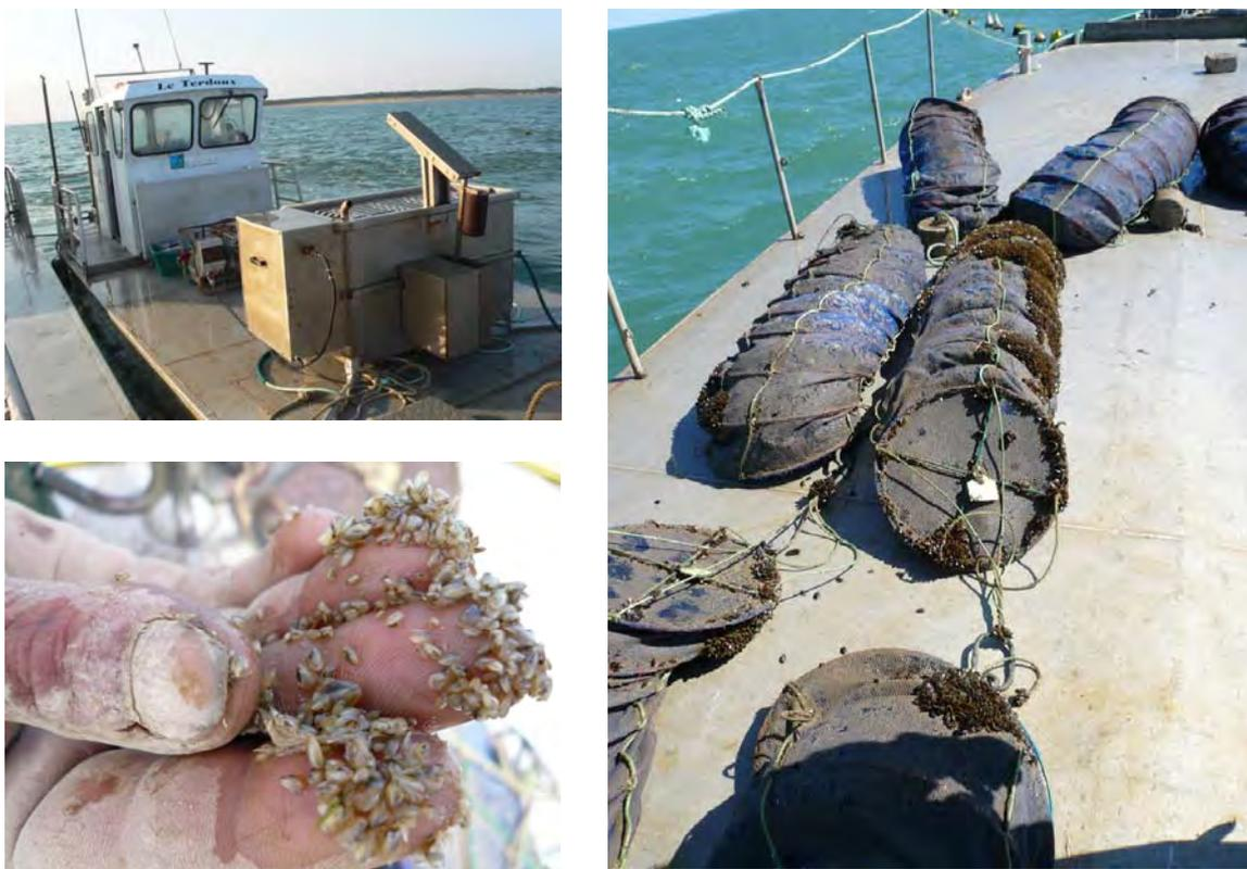
*Figure 19 : Nettoyage par échaudage à l'eau chaude : machine au gaz (en haut à droite), jeunes naissains de moules détruits d'une taille de 5 à 10 mm (en bas, à gauche) et lanternes remontées après un précédent échaudage (à droite) qui a laissé des moules dans les plis du filet pendant le traitement. On remarque la propreté des autres parties du filet.*
