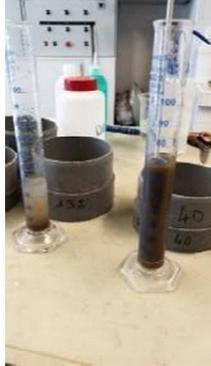
Figure 3 : Epprouvettes avec échantillons filtrés sur 40 µm et 132 µm.
