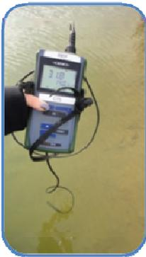
Figure 8 : Conductimètre WTW destiné à mesurer la salinité et la température de l'eau
