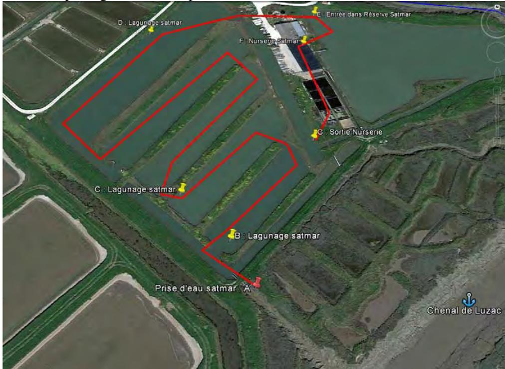
Figure 22 : Circuit d’eau (trait rouge) entre la nurserie (points jaunes F et G) alimentée par l’eau du chenal de Luzac (prise d’eau : point orange A) via le lagunage (points jaunes B, C D, E), sur le site de La Satmar, commune de Saint Just Luzac, 17320.
