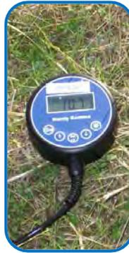
Figure 9 : Oxymètre de type Oxyguard destiné à mesurer l'oxygène dissous dans l'eau.
