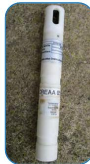
Figure 11 : Sonde multiparamètres TPS (Température, Pression, Salinité).
