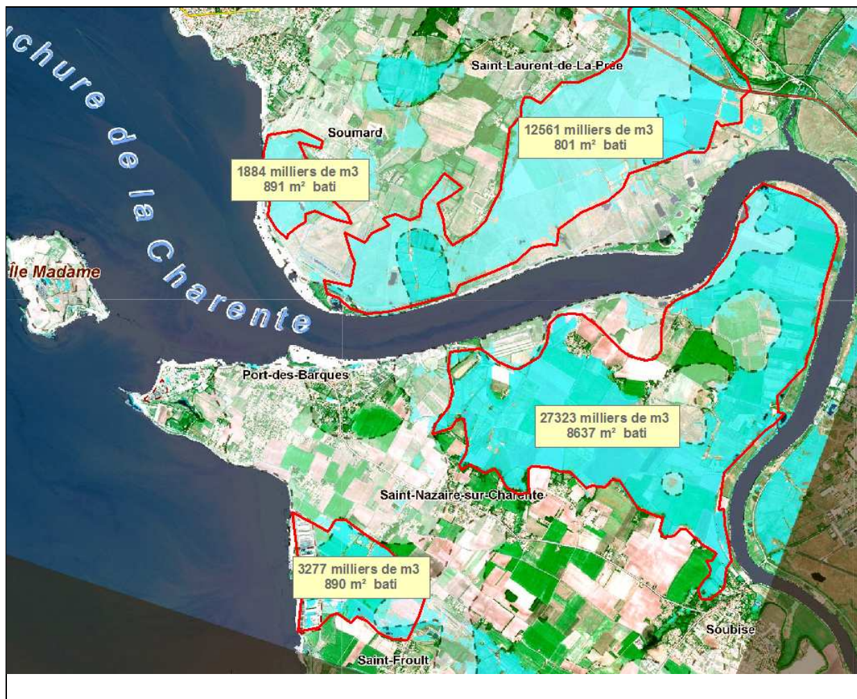
Figure 16 : Numérisation des zones submergées, estimation des volumes et des risques de contamination engendrés par les bâtiments submergés.
